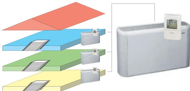
МАЛОЕ решение представляет собой систему из основного и подчиненного (вспомогательного) устройства, расширенную до 247 терминалов, в которых пульта управления EVO или MYCOMFORT СРЕДНИЙ или БОЛЬШОЙ соединены вместе, и одни из них, особым образом сконфигурированный, имеет функцию ГОЛОВНОГО устройства.
